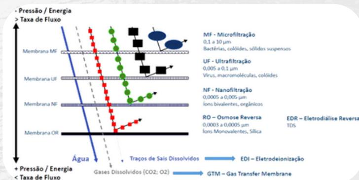
Por outro lado, moléculas de água que são bombeadas em altas pressões tangencialmente à esta parede de membrana, a atravessam, criando um fluxo de produto purificado chamado de permeado. A rejeição de sais dissolvidos fica acima de 99% criando o fluxo que conhecemos por rejeito.
