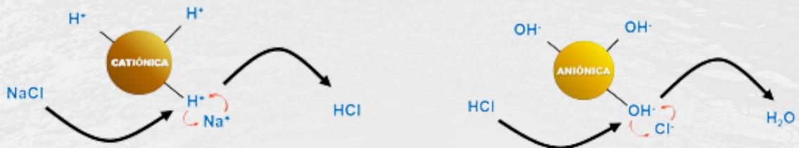
Este processo apresenta ampla utilização pela seletividade dos sais que se deseja remover, o que torna sua operação muito econômica em processos em que não se requer a retirada completa dos contaminantes, como a remoção de dureza, sais compostos por cálcio e magnésio, em abrandadores, por exemplo. Adicionalmente, sua simplicidade operacional, construtiva e qualidade final da água tratada que pode alcançar os padrões de remoção salina mais puros sem grandes investimentos o tornam a escolha ideal.
