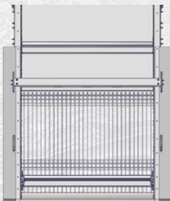
*Grade de barras com espaçamento < 12 m possuem um perfil funcional em forma de gota, resultando em uma baixa perda de carga e evitando obstrução*
