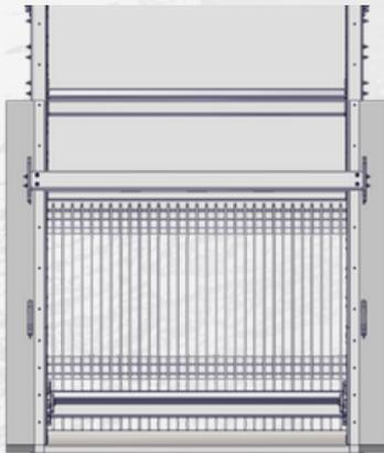
*Rastelos aparafusados às correntes de acionamento que podem ser trocadas no caso dos dentes serem danificados ou desgastados; os mancais de cerâmica dispensam manutenção (sem lubrificação)*
