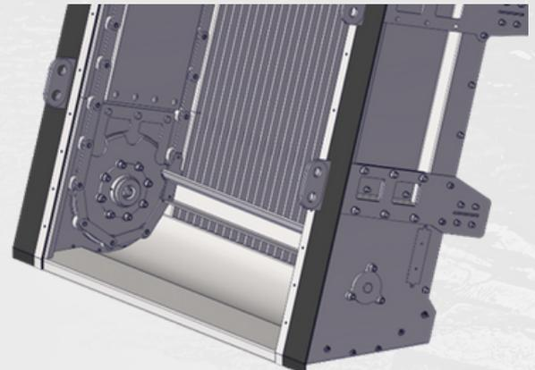
*Rodas dentadas e correntes são feitas 100% em aço inoxidável a fim de proporcionar baixo desgaste e proteção anticorrosiva.*
