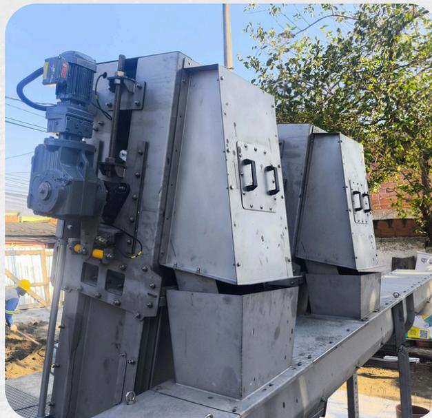
►►► Dimensões: Espaçamento das barras: 6 a 150 mm Largura do canal : Até 4 m
