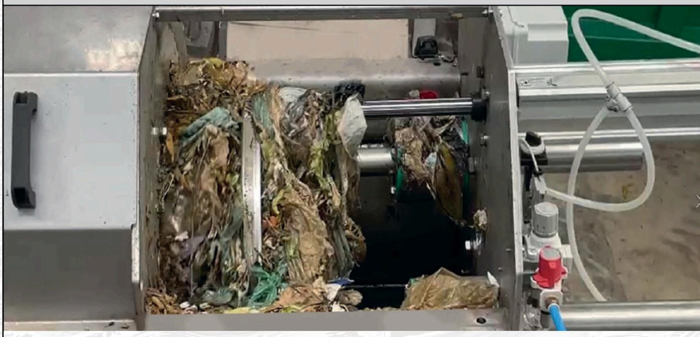
O rejeito é alimentado na **Rosca Compactadora** e transportado por uma espiral de alta espessura até a câmara de compactação. Um contrapeso, acionado pneumaticamente, cria o efeito de compactação antes da descarga.
